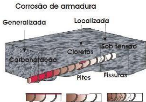
Figura 6- Tipos de corrosão em armaduras
