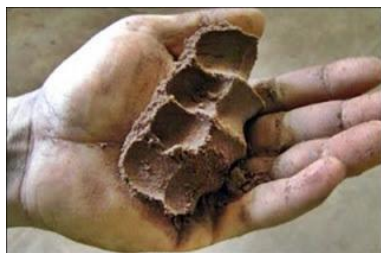
Figura 3 – Teste de quantidade de água.
