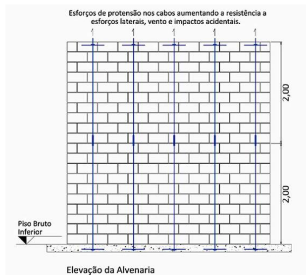
Figura 3: Alvenaria estrutural armada de blocos vazados de concreto
