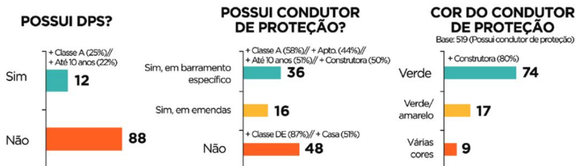
Figura 2: Ausência de componentes de segurança da Instalação elétrica. Fonte: ABRACOPEL; PROCOBRE. 2017.
