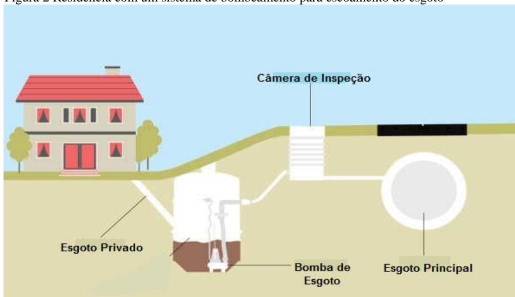
Figura 2 Residência com um sistema de bombeamento para escoamento do esgoto
