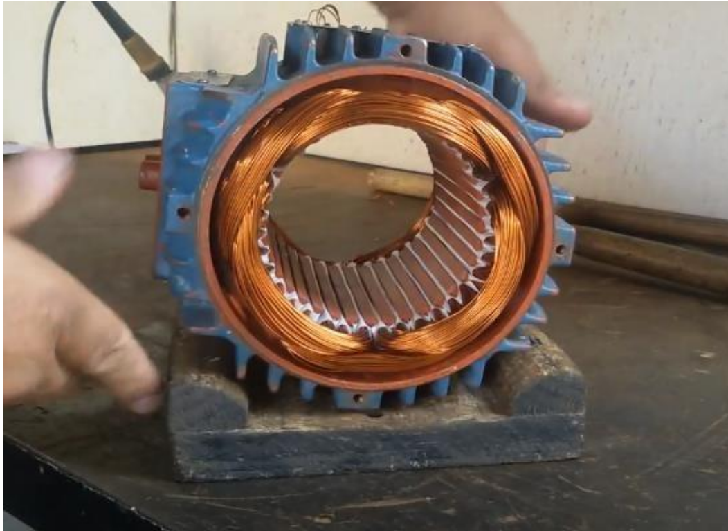
Figura 2: Enrolamento do motor finalizado Fonte: Autor, 2020
