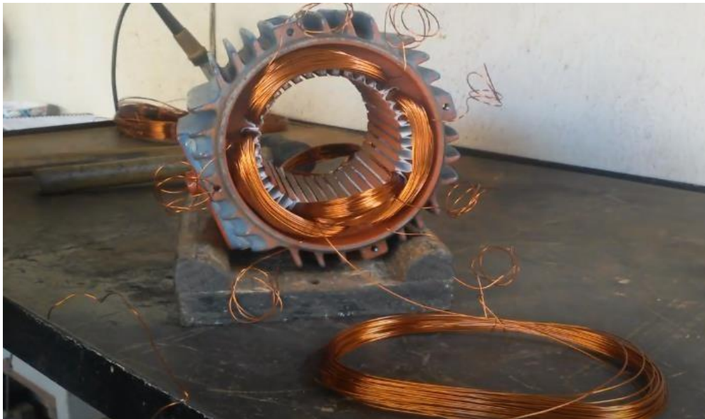
Figura 1: Motor Trifásico 1,5 CV em fase final de rebobinamento
